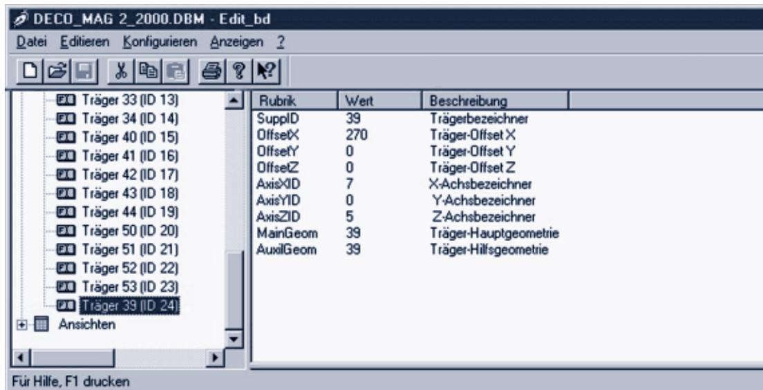
Einen neuen Datenträger generieren, dessen Eigenheit es ist, als Referenz-Achse in X, die Achse X3 zu haben und als Referenz-Achse Z, die Achse Z1. Die Standard-Träger T31 bis T34 haben als Referenz-Achsen die Achsen X3 und Z3. Die Daten-Trägernummer ist 39. Um diesen neuen Datenträger zu generieren, wird die Anwendung Edit\_bd gebraucht. Nun brauchen Sie nur noch Folgendes zu tun.
