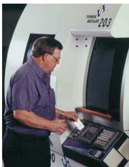
Tony Clark überspielt gerade das auf einem Personal Computer programmierte und auf einer Chipkarte gespeicherte TB-DECO-Programm auf die Maschine.
