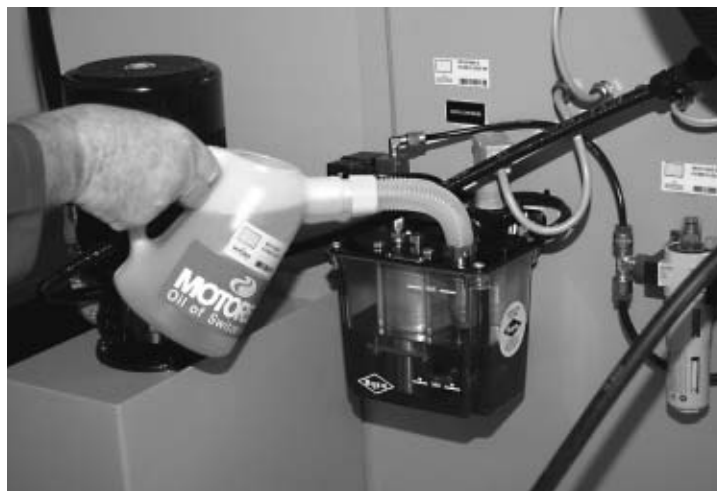
Die Verwechslungsgefahr ist gebannt und das Nachfüllen kann auch von Personal ohne Sachkenntnisse ausgeführt werden.
