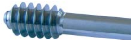
Nebenzeitliches Gewindewirbeln in Gegenbearbeitung (3 Schruppdurchgänge, Schlichten).
