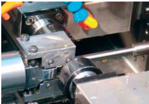
Fraisage du 6 pans extérieur avec 2 outils simultanément et support de pièce en bout.
