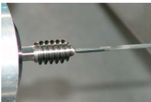
Perçage haute pression 120 bars au canon et en contre- opération.
