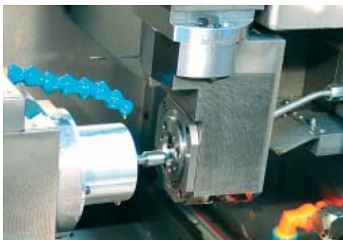
Tourbillonnage del filetto in contro-operazione (3 passate sbizzo finitura) in tempo mascherato.
