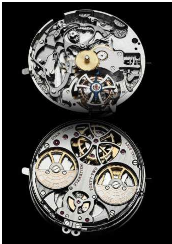
Rundes Kaliber RD08, mechanisches Werk mit Handaufzug und doppeltem Fliehgewicht, 14,111 Linien, 42 Rubine, rhodiniert, Dekor „Genfer Streifenschliff“. Besonderheit: fliegendes Tourbillon, Minutenrepetition, Schlagwerksaufzug über die Lünette, Tourbillon-Gestell bei 5 Uhr sichtbar. Das Kaliber RD08 besteht aus 398 Teilen!
