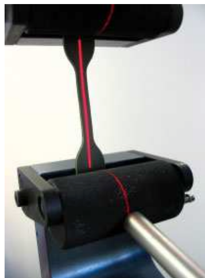
Im Parker®-Test werden verschiedene Prüfverfahren angewendet: Hier wurde ein HNBR-Prüfstab in das Schneidoeel eingelagert um diesen anschliessend einem exakt definierten Prüfverfahren zu unterziehen.
