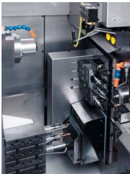
Ansicht des Bearbeitungsbereichs der Drehmaschine DECO 20a mit verschiedenen, voreinstellbaren Schnellwechsel-Werkzeugsystemen
