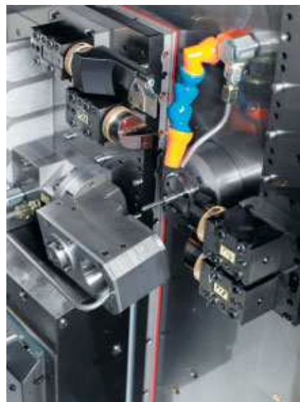
Bearbeitungsbereich der Drehmaschine DECO 20a mit der von TORNOS entwickelten Vorrichtung zum Gewindewirbeln (Außengewinde).
