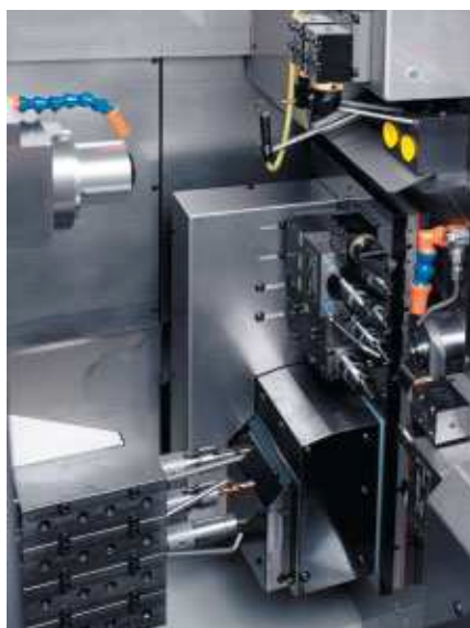
Vue de la zone d'usinage du tour DECO 20a équipé avec les différents systèmes d'outils à changement rapide préréglables.
