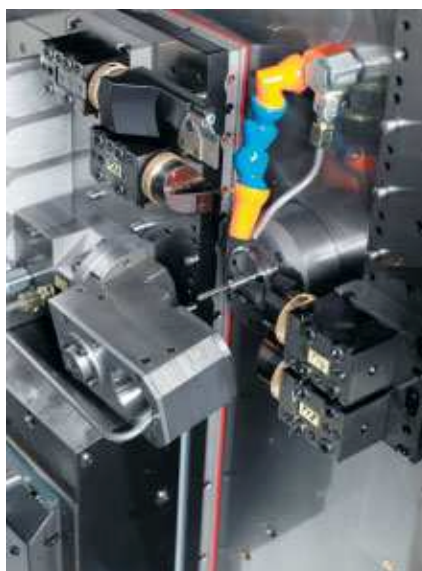
Zone d'usinage au canon du tour DECO 20a avec l'appareil à tourbillonner les filets extérieurs développé par TORNOS.
