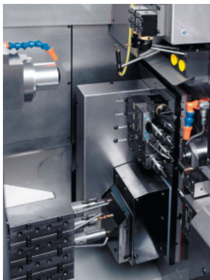
Vista della zona di lavorazione del torio DECO 20a equipaggiato con i diversi sistemi di utensili a cambio rapido preregolabili.
