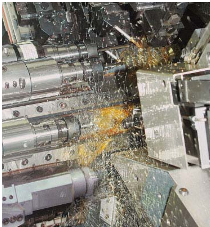
Acht auf einen Streich; bei der MultiDECO 20/8d sind gleichzeitig 8 drehzahlunabhängige Spindeln im Einsatz. Die Produktivität bei komplexen Teilen steigt im Quadrat! Je nach Auftragsstruktur lohnt sich die Anschaffungsevaluation eines Mehrspindel-Drehautomaten.
