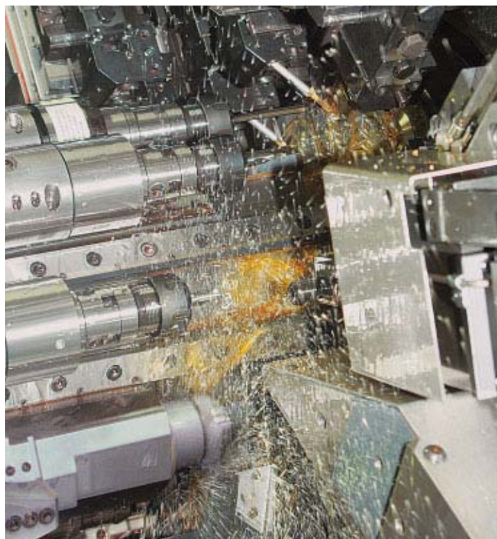
Otto in azione: sulla MULTIDECO 20/8d, 8 mandrini con velocità di rotazione indipendenti sono messi in opera simultaneamente. La produttività per i particolari complessi è aumentata di una doppia potenza! A seconda dell'entità dell'ordine, può valer la pena di prendere in considerazione l'acquisto di un tornio automatico multiman-drino.
