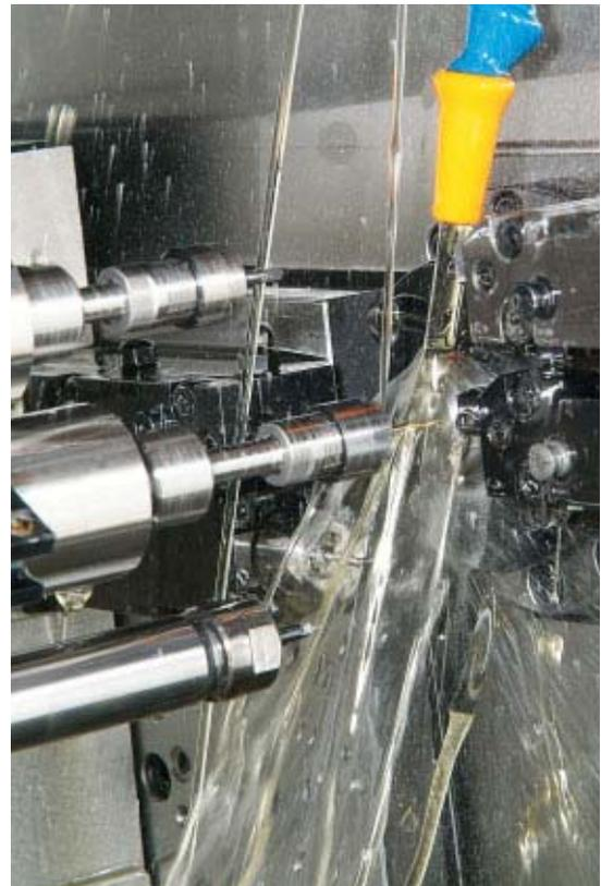
Innenansicht einer der DECO-Maschinen – oben der nutzwolle Polygonfräsapparat.
