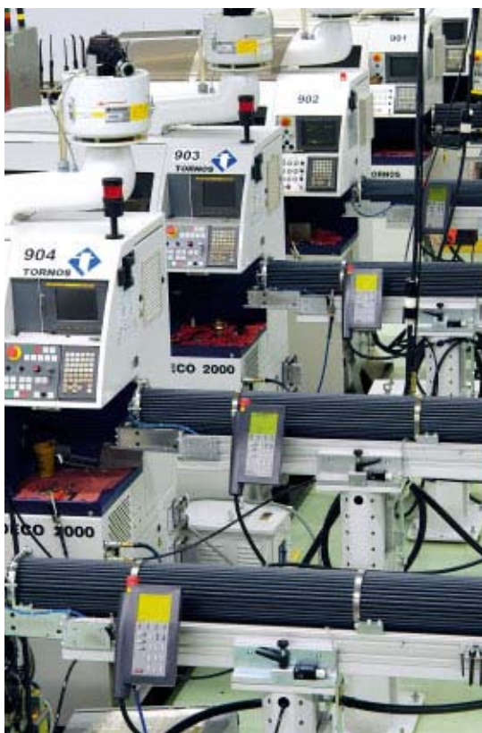
L'azienda possiede otto macchine 9-assi Tornos DECO 10 mm per realizzare operazioni multiple complicate in una sola passata in macchina, la capacità di realizzare operazioni di fresatura poligonale è una delle loro maggiori prerogative.
