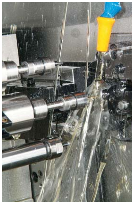
Veduta interna di una delle macchine DECO - in alto il prezioso apparecchio di fresatura poligonale.
