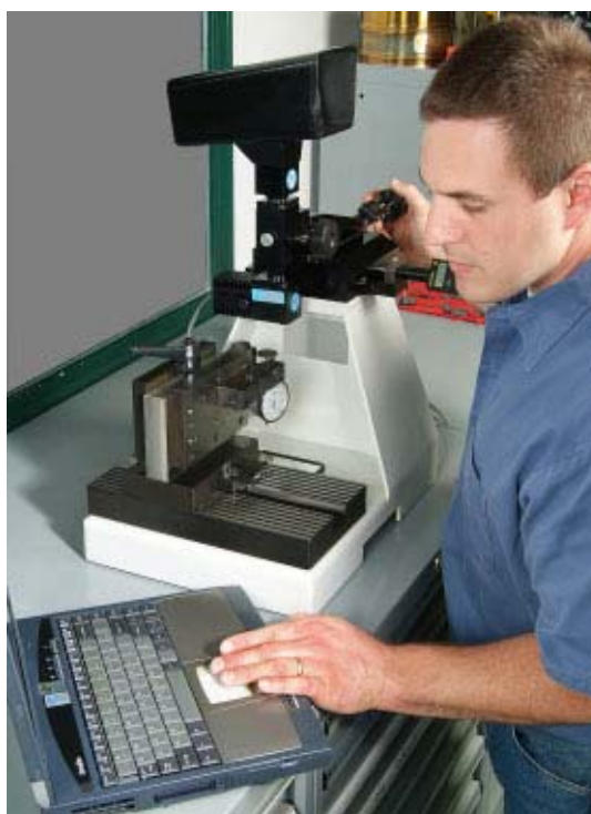
Con le sue DECO, Tornos fornisce un banco di prerogolazione per garantire la regolazione degli utensili per la serie successiva mentre le macchine continuano a produrre.
