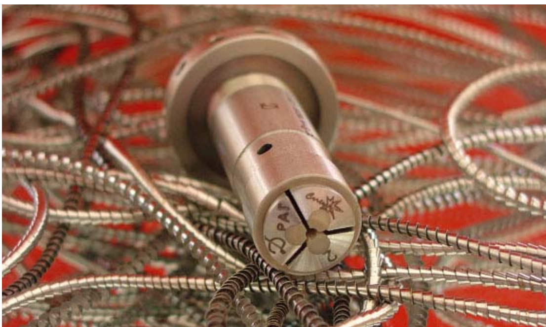
Il sistema di cannone di guida MAGIC, accuratamente studiato dalla Ditta Walter Dünner SA, consente, in maniera totalmente automatica, l'apertura e la chiusura del cannone. Quando una barra viene lavorata sino a ch  non ne rimane che un pezzettino, l'espulsione di quest'ultimo dal cannone risulta semplificata. Ad avvenuta introduzione della nuova barra, il cannone di guida MAGIC si adegua automaticamente al valore predefinito.
