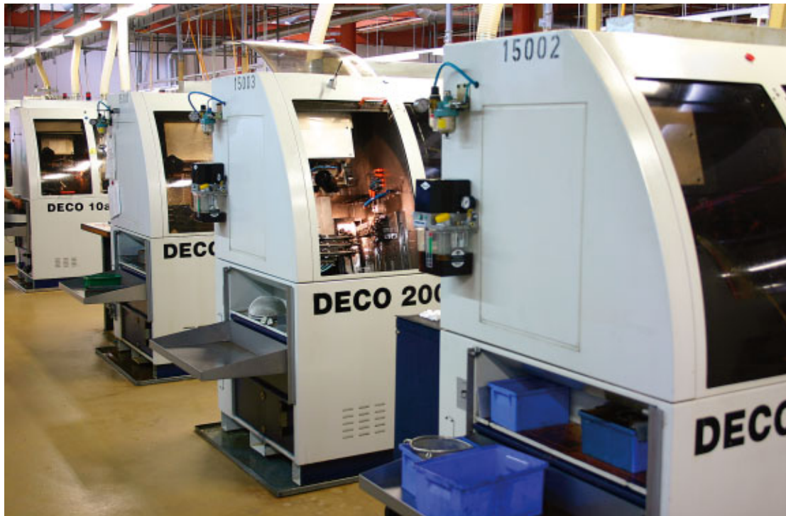
Ein Drittel des Maschinenparks besteht aus CNC-Drehautomaten von Tornos.
