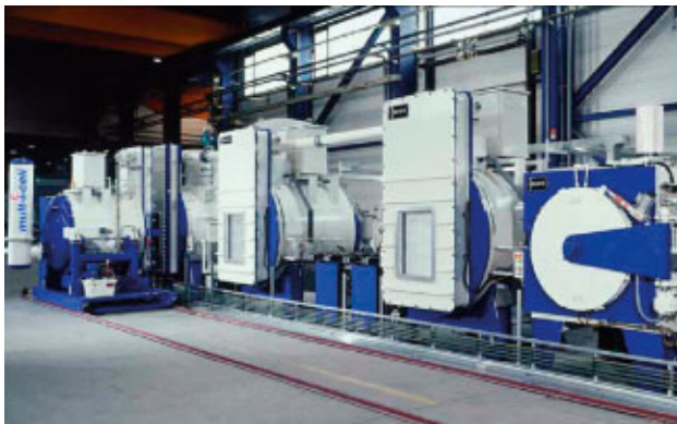
Multi-i-cell Anlage für innovative Härteverfahren.
