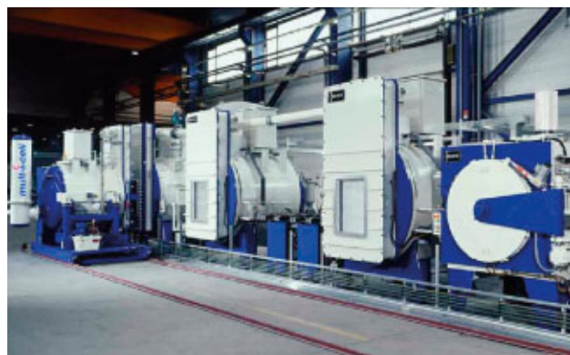
Impianto di tempra di ultima generazione Multi-i-cell.
