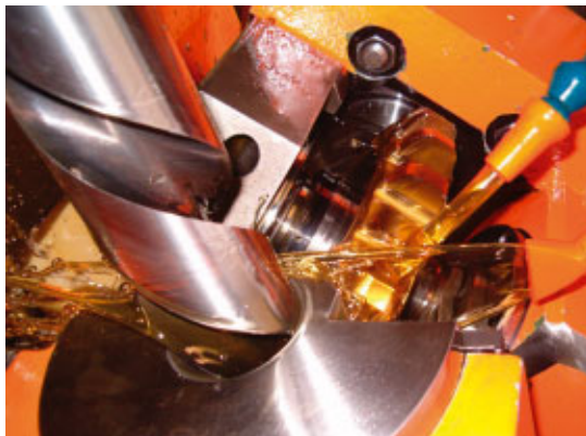
MOTOREX ORTHO NF-X weiss trotz seiner Dünnflüssigkeit von ISO 15 durch extreme Hochdruckstabilität zu überzeugen. Das Werkstück wird optimal gekühlt, die Späne rasch abgeführt und durch diese kaum Öl ausgetragen.
