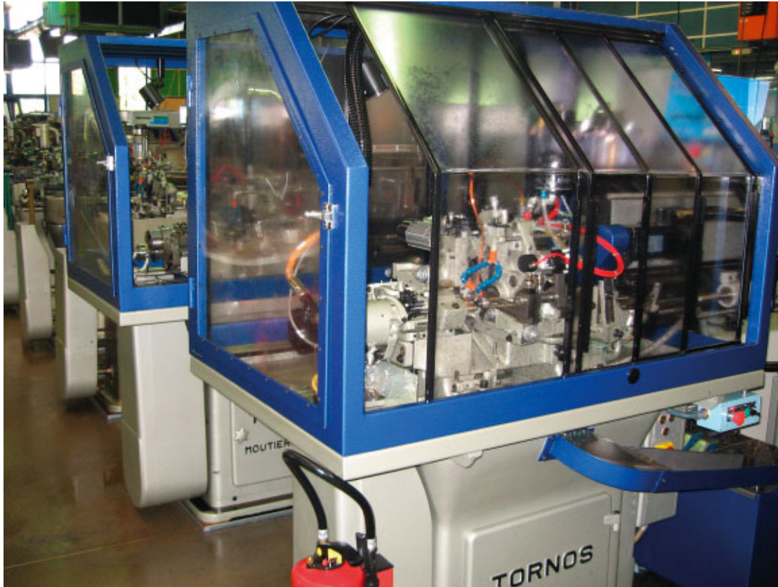
Nach und nach werden bei UND – sowie auch anderswo – alle kurvengesteuerten Maschinen nachgerüstet und in Übereinstimmung mit den Sicherheitsnormen gebracht.
