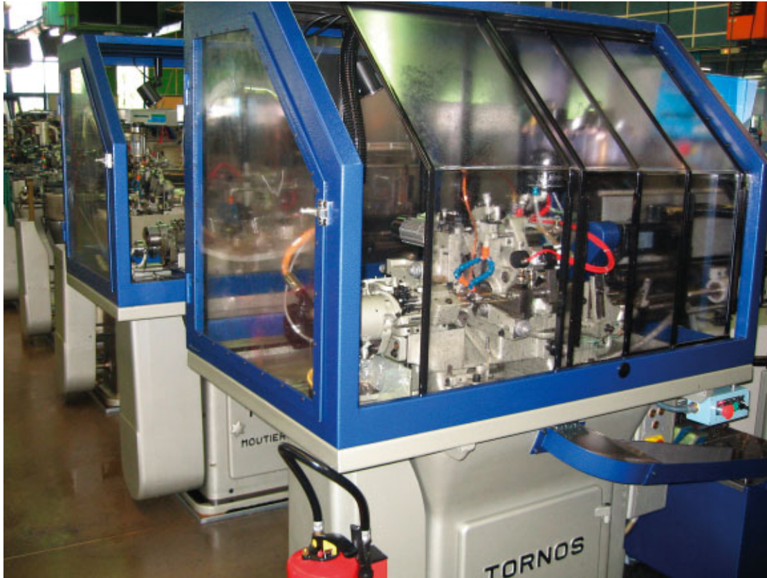
De forma progresiva, todas las máquinas de levas de UND, e incluso las de otras empresas, se actualizan y se modifican para que cumplan las normas de seguridad.
