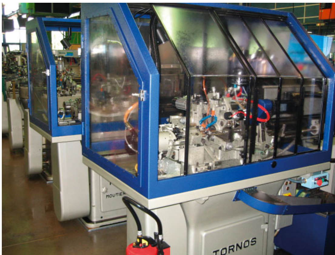
Tutte le macchine a camme presenti presso la UND, e anche altrove, sono sottoposte a retrofit e messe a norma di sicurezza.
