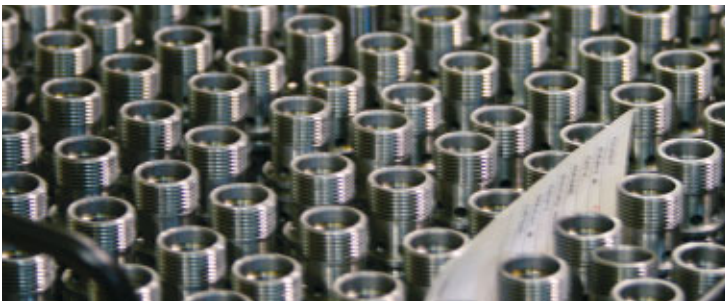
Nahaufnahme der fertigen DECO-Teile in Kisten für die Wärmebehandlung.
