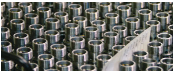
Primeros planos de piezas DECO acabadas en sus cajas preparadas para tratamiento térmico.
