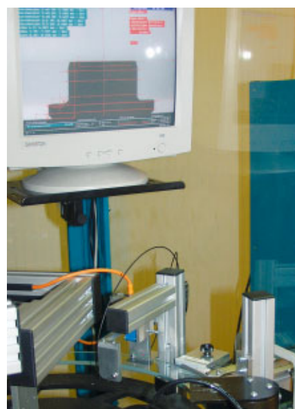
Automatisches, hochgenaues Messen von Décolletageteilen basiert auf einem vorgegebenen CpK-Wert. Die Teile werden stichprobenweise gemessen und mit einer Sollmasszeichnung verglichen.
