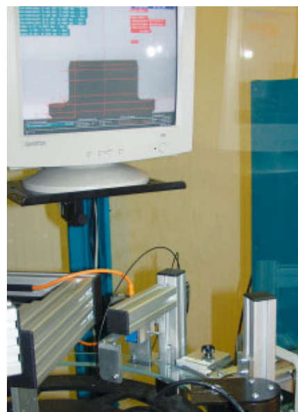
La medición automática y de gran precisión de las partes de mecanizado se basan en un valor Cpk predeterminado. Las piezas se miden realizando un muestreo y se comparan con una medida de referencia utilizando el micrómetro.
