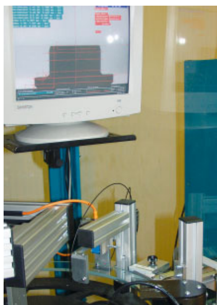
L'altamente precisa misurazione automatica di particolari torniti si basa su un valore CpK predefinito. I particolari vengono misurati, a caso, in una campionatura e confrontati con le quote riportate su un disegno - sfiorando il micron!
