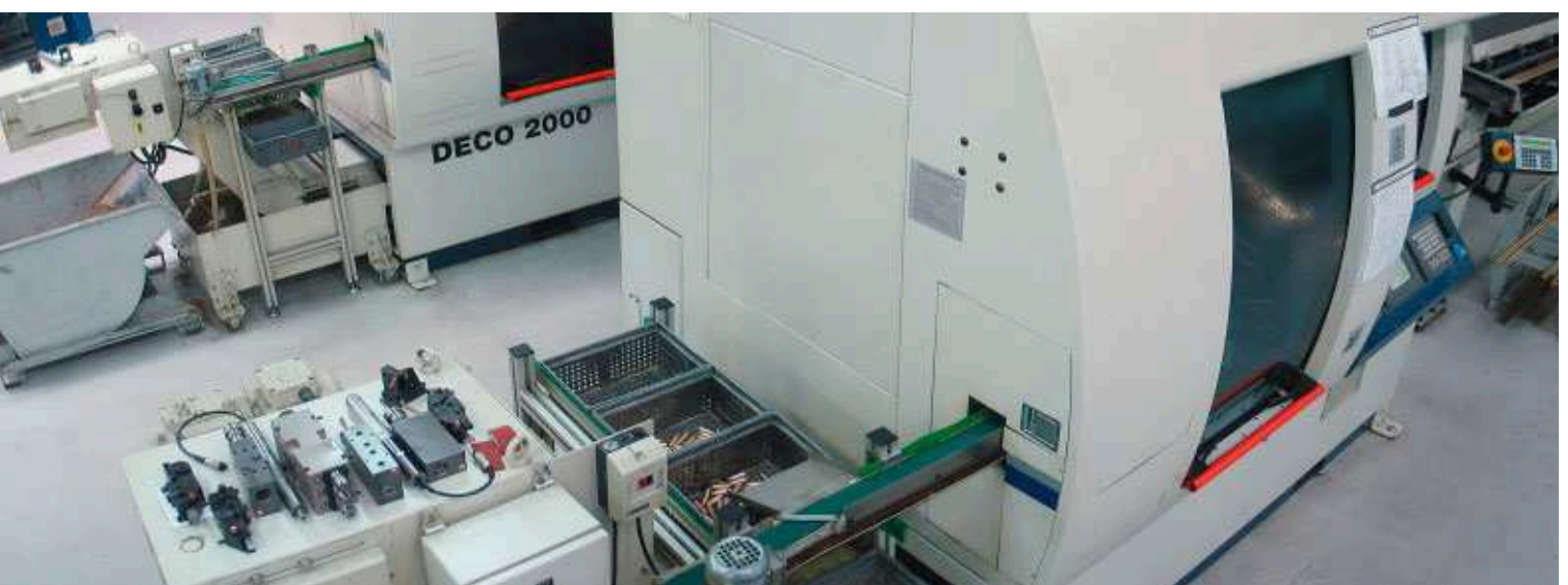
DECO-Produktionszelle. Im Vordergrund die Geräte und Werkzeuge, die für die Bearbeitung der nächsten Serie aufmontiert werden.
