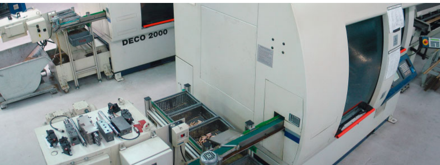
Cellula di produzione DECO. Si possono vedere in primo piano gli apparecchi e gli utensili pronti ad essere montati per la lavorazione della serie successiva.
