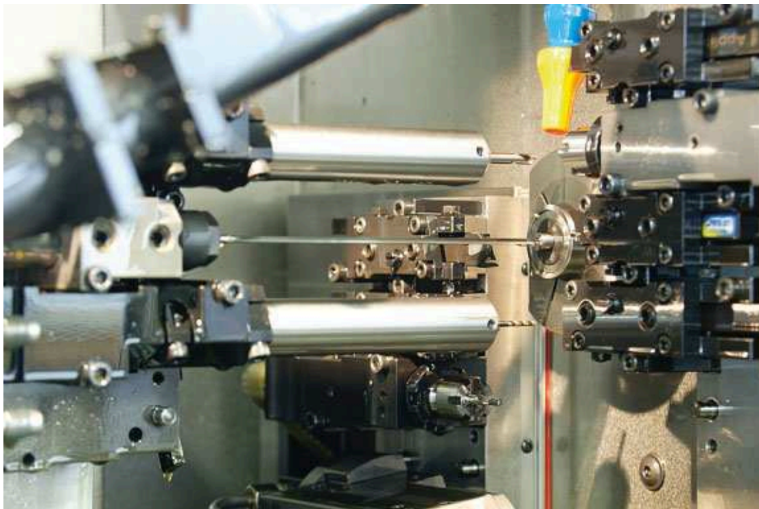
Beim Tieflochbohren wird normalerweise mit sehr hohen Schneiddrücken und -Fördermengen gearbeitet. In diesem Fall wurde mit ORTHO NF-X eine Bohrung (108 mm tief) mit nur 40 bar Schneiddruck perfekt realisiert.
