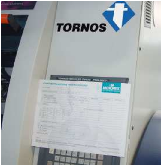
Auf dem von MOTOREX entwickelten Schnittdaten-Kontrollblatt können alle relevanten Parameter gut vergleichbar aufgeführt werden. Das Blatt lässt sich einfach an der Maschine per Magnet aufhängen und anschliessend mit dem Musterteil archivieren.
