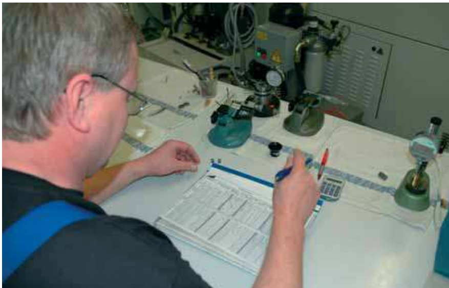
Auf den Hundertstel genau genügt manchmal kaum noch. Durch regelmässiges Ausmessen und das Führen eines aussagekräftigen Messprotokolls während der Serienproduktion weiss der Maschinenführer woran er ist.
