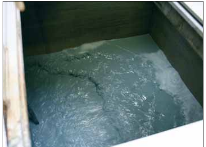
Durch intensives Vermischen von Zusatzstoffen mit der Alt-emulsion wird der Emulgator geknackt.
