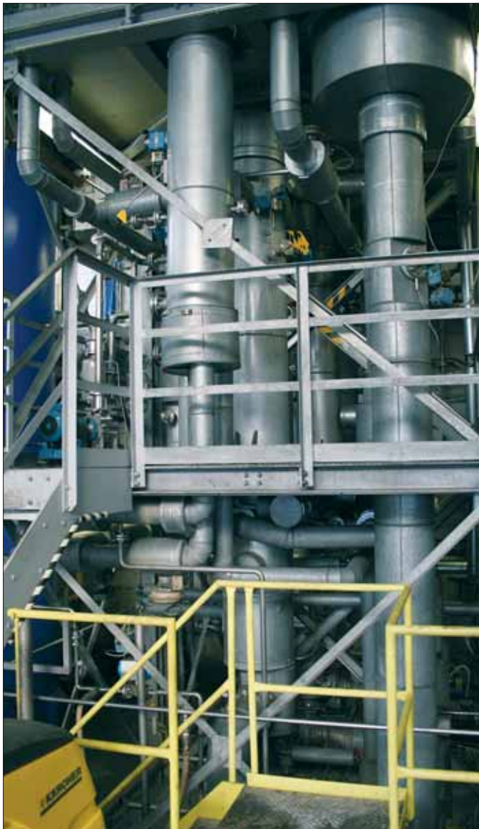
Kein Chemiewerk, sondern die dreistufige Vakuum-Verdampfungsanlage, welche aus Schmutzwasser ein sehr reines Produkt macht.
