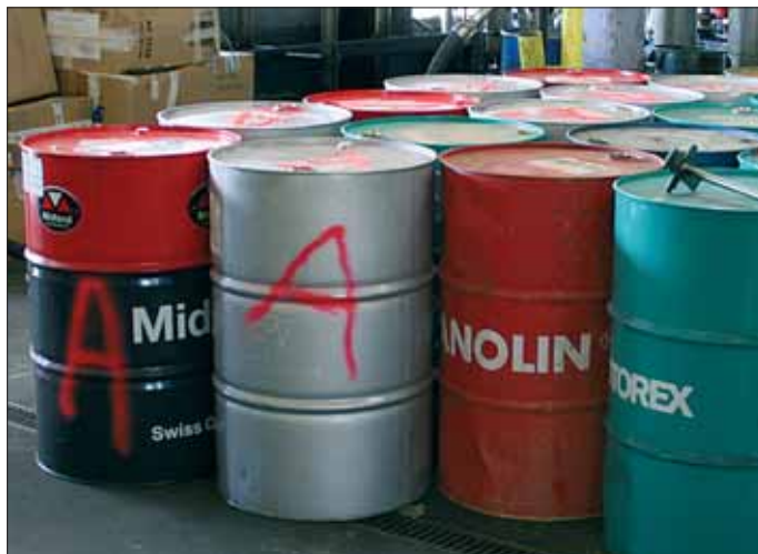
Les huiles usées de provenance les plus diverses sont examinées et selon leur état, soit utilisées comme combustible, soit régénérées.
