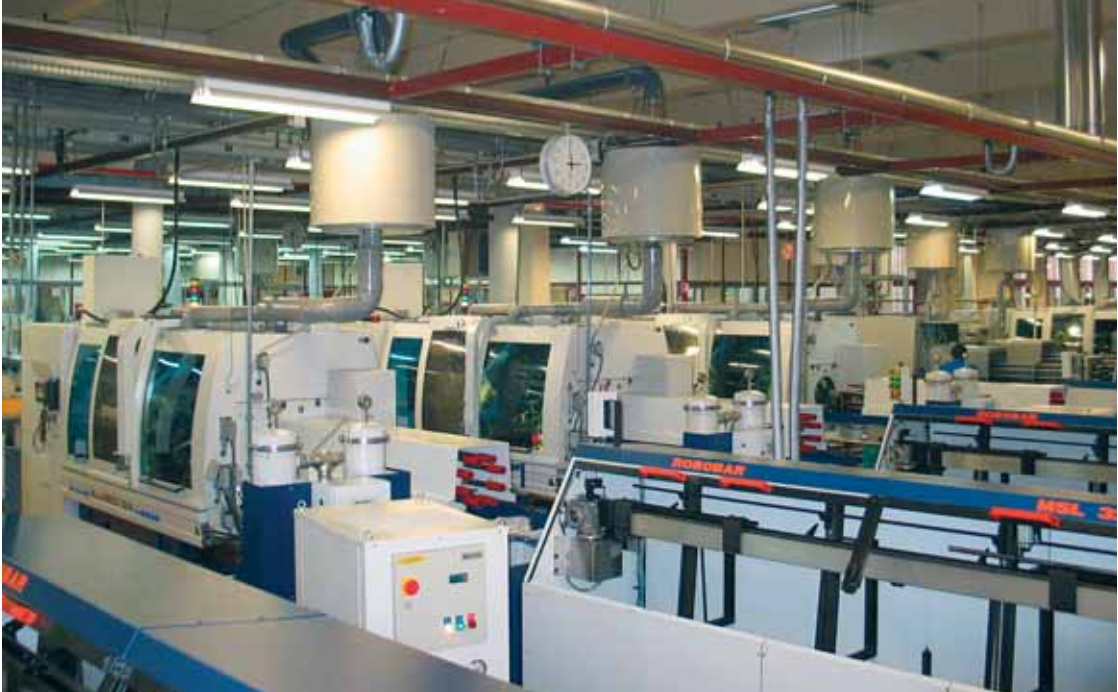
Rund zehn CNC-Mehrspindelmaschinen MultiDECO ermöglichen Joseph Martin SA Serien von 30 bis 50'000 Teilen äusserst rationell zu fertigen.
