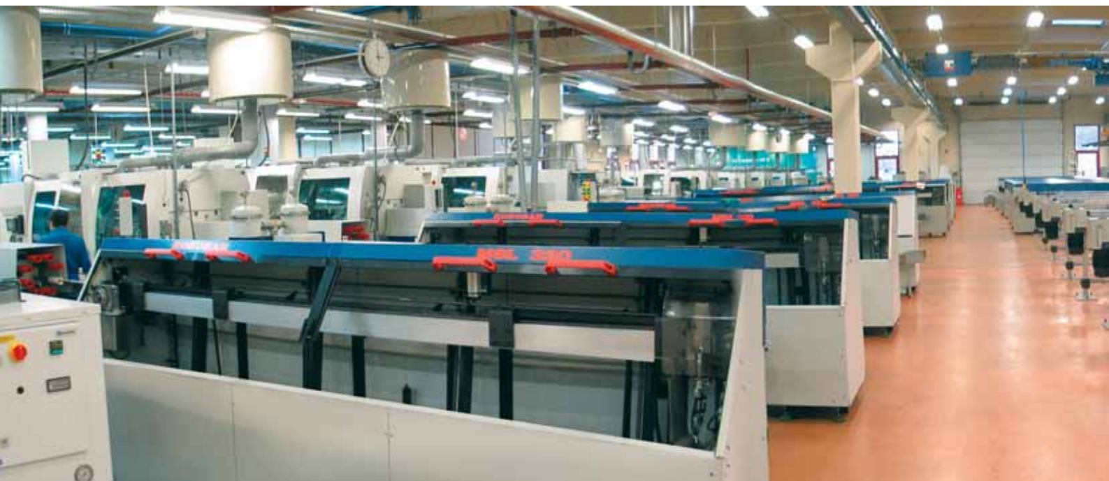
Werkstatt mit Mehrspindeldrehmaschinen von Joseph Martin SA, drei Maschinengenerationen, von links nach rechts: MultiDECO, SAS und AS/BS. Alle Maschinen sind wie neu, so gut werden sie gepflegt.
