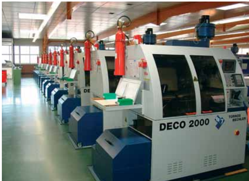
Bei MGB sind alle Maschinen mit den notwendigen Vorrichtungen für die Produktionssicherheit ausgestattet, zum Beispiel mit Brandschutzsystemen.
