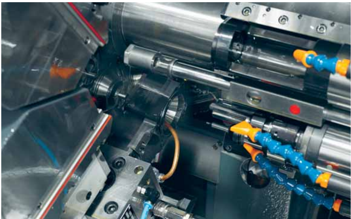
Un des deux appareils à tourbillonner qui effectue «la moitié» du travail.
