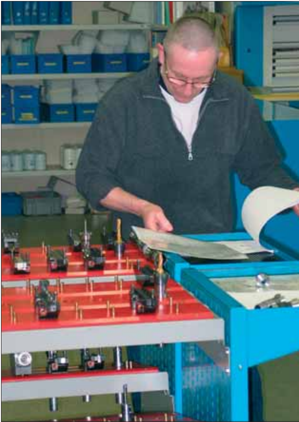
Preparación previa del material para realizar una nueva serie; la parada de la máquina se reduce al mínimo.
