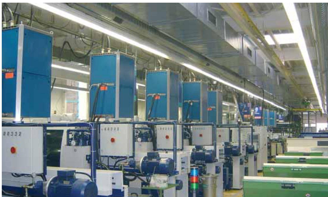
Tutte le macchine sono raccordinate ad un'installazione di aspirazione centrale e funzionano in modo affidabile e, in prevalenza, ininterrottamente.
