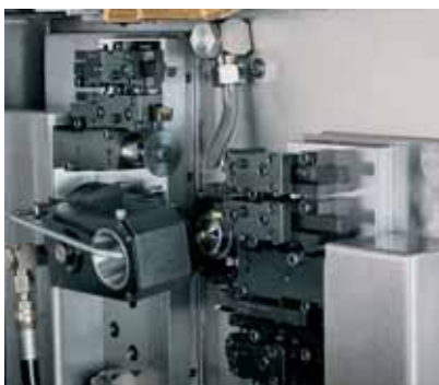
Gewindewirbeln mit der DECO 13a.
