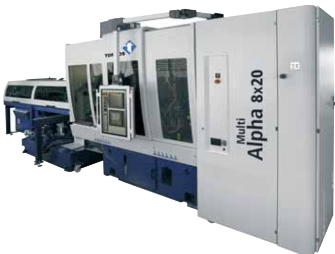
MultiAlpha 8x20: Das erste Mehrspindelsystem, das Gewindewirbeln ermöglicht.
