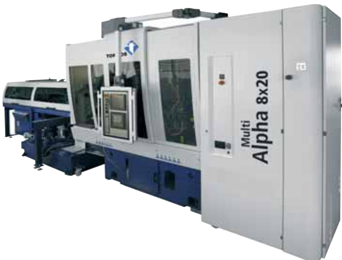
MultiAlpha 8x20: El primer multihusillo en utilizar el proceso de torbellinado de roscas.
