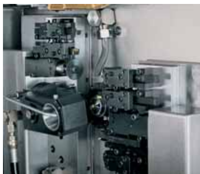
Dispositivo di tourbillonnage su una DECO 13a.
