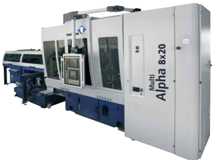
MultiAlpha 8x20: La prima multimandrino ad utilizzare un processo di tourbillonnage.
