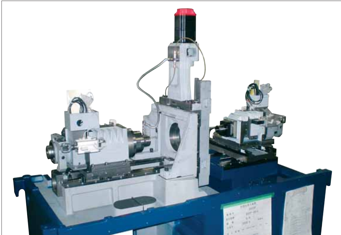
Das auf einer soliden Gusseisenbasis aufgebaute Maschinenbett und die grosszügig dimensionierten Werkzeugsysteme gewährleisten Präzision und Qualität.
