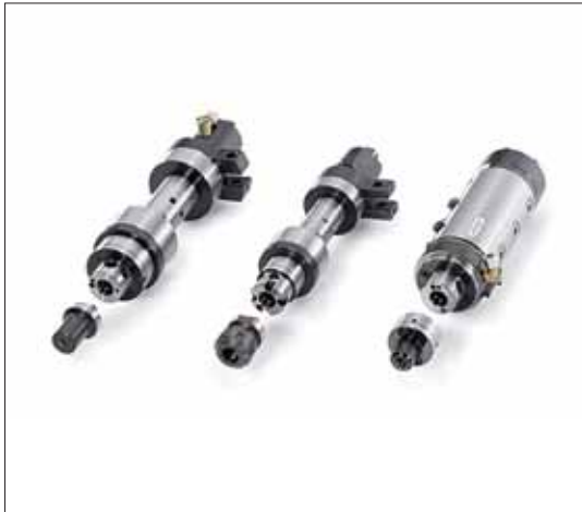
Husillos de taladrado rápido GWS con alimentación interna de refrigerante hasta 100 bar.
