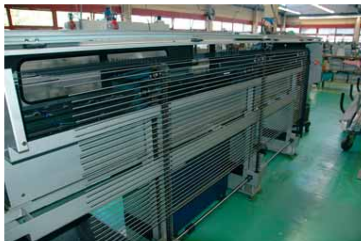
Die Beschickung der sechs Spindeln wird vollautomatisch durch den Stangenlader Typ Robobar MSF 316 vollzogen. So kann auch in unbemannten Schichten uneingeschränkt und effizient produziert werden.
