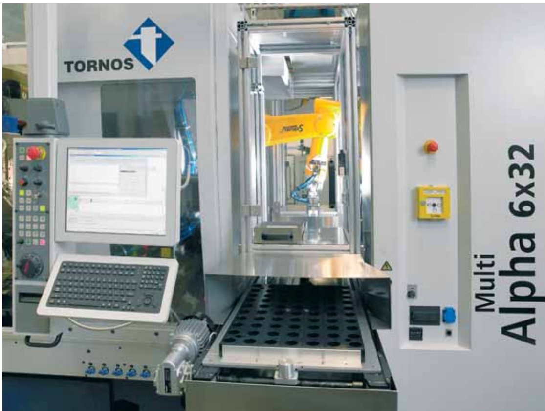
Die Maschine ist perfekt abgestimmt für die Integration von Peripheriesystemen – hier der Roboter der MultiAlpha 6x32 und die Steuerung mit integriertem PC.
