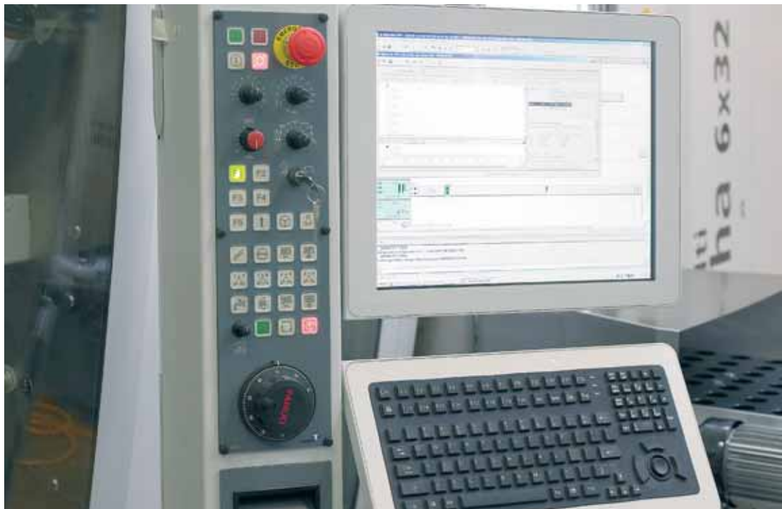
Con su teclado inclinable que cuenta con un ratón integrado, el nuevo control de Tornos permite una fácil programación, incluso en la máquina.
