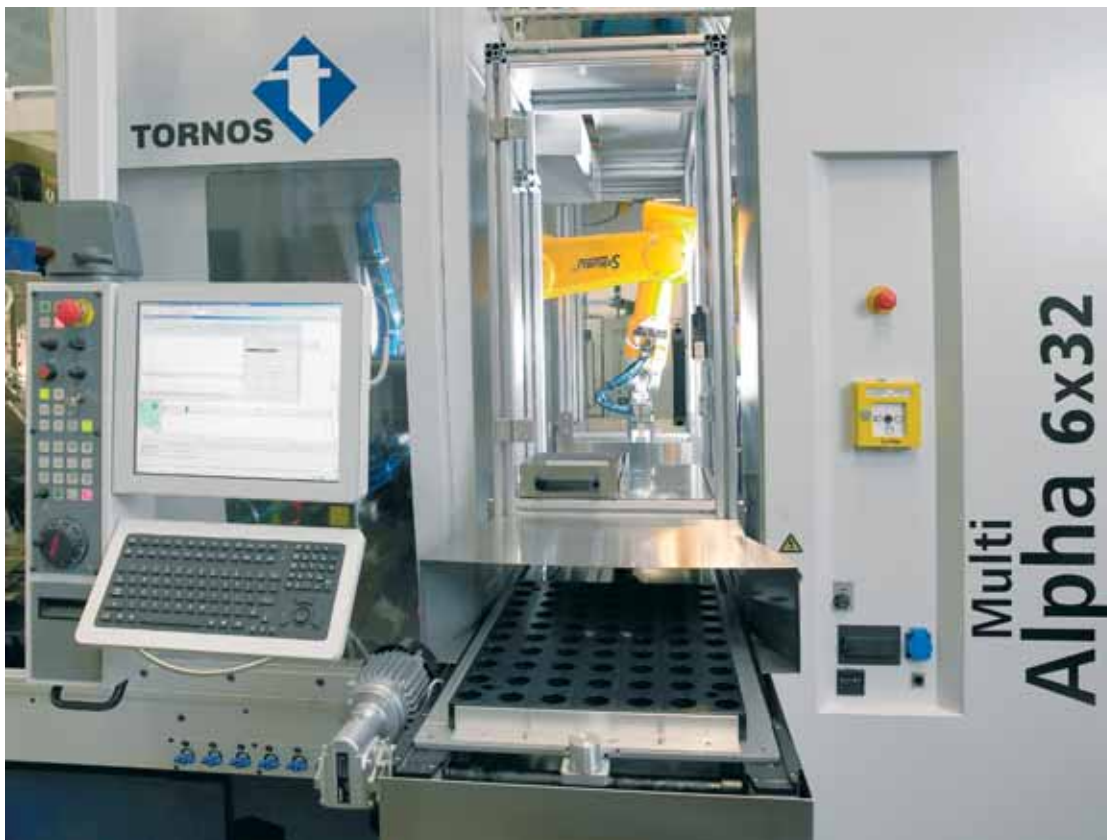
La integración de periféricos es totalmente coherente; aquí el robot de MultiAlpha 6x32 y el control con PC integrado.
