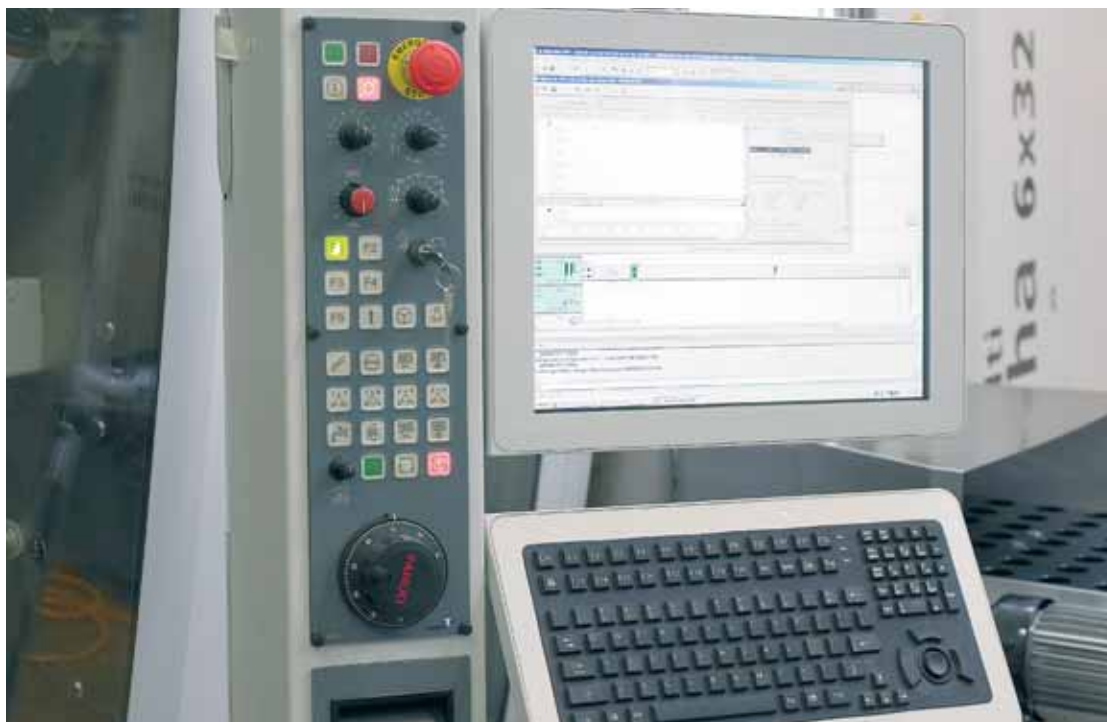
Avec son clavier inclinable comportant une souris intégrée, la nouvelle commande Tornos permet une programmation aisée, même sur la machine.
