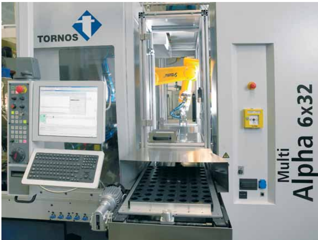
L'intégration de périphériques est parfaitement cohérent, ici le robot de MultiAlpha 6x32 et la commande avec PC intégré.
