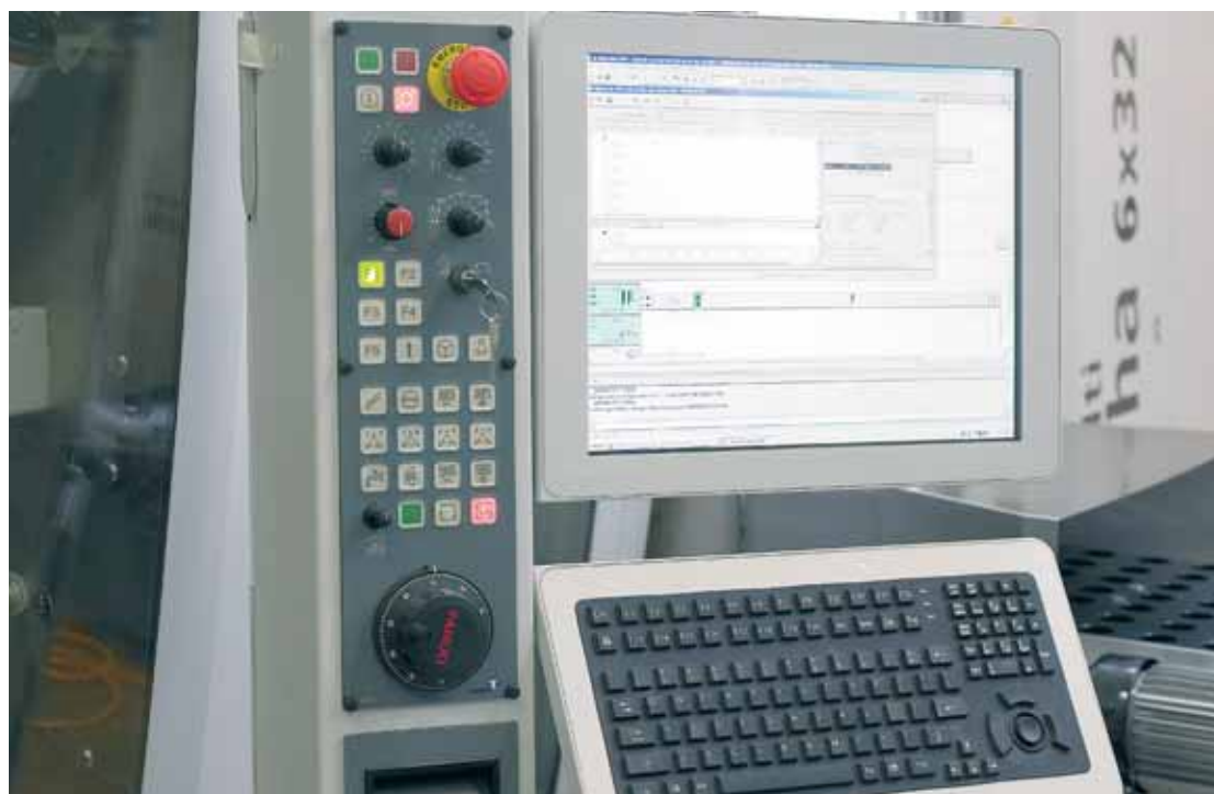
Con la sua tastiera inclinabile, nella quale è integrato il mouse, il nuovo comando Tornos consente un'agevole programmazione anche sulla macchina.
