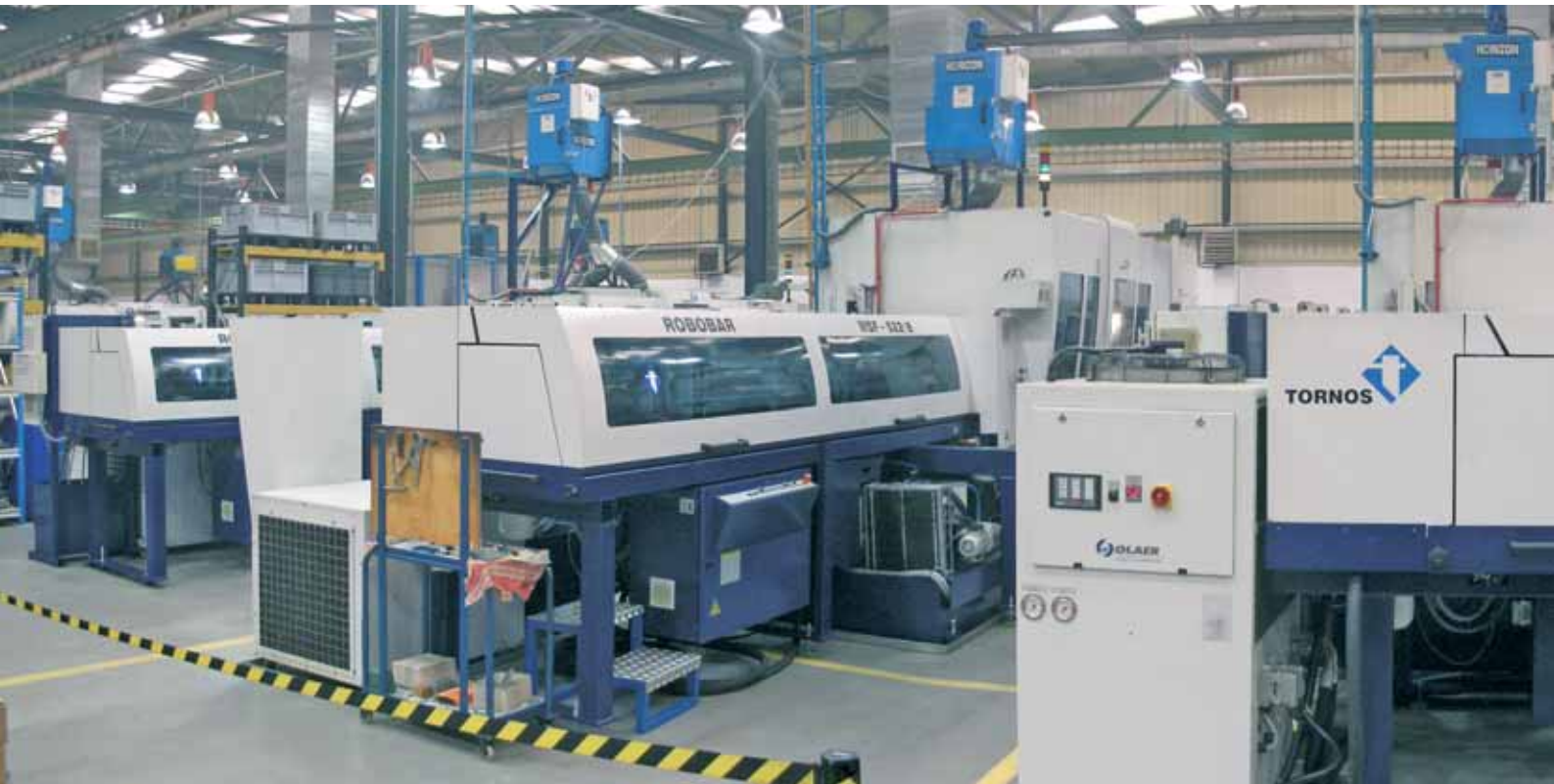
Die Maschinen MultiAlpha und MultiDECO bieten Microdeco ein ausserordentliches Potenzial. Jede Maschine ist mit einem Ölnebelabscheider ausgestattet, um die bestmöglichen Arbeitsbedingungen zu gewährleisten.
